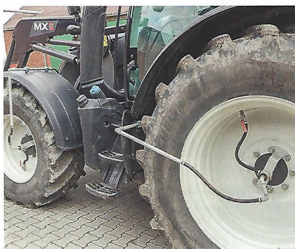
Die Reifendruckregelanlage von Strotmann funktioniert sehr gut, hält aber über Nacht nicht dicht, wenn die Kugelhähne offen bleiben.
