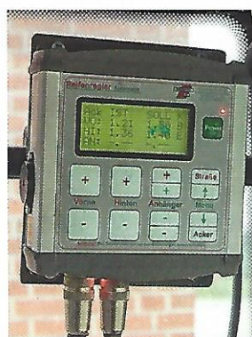
Die Reifendruckregelanlage von Strotmann funktioniert sehr gut, hält aber über Nacht nicht dicht, wenn die Kugelhähne offen bleiben.
